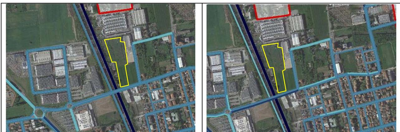
Un lieve decremento (da 45 a 30 Km/h) di velocità scaturisce nel tratto di Via Pastrengo in direzione Ovest tra Via Brennero e Merano e il tratto terminale di Via Pastrengo all'innesto con l'asse di Via Petrarca. Per contro si verifica un aumento di velocità (da 45 a 60 Km/h) nel tratto iniziale di Via Petrarca all'uscita dell'intersezione, in rotatoria, con la SS35, direzione Est.
