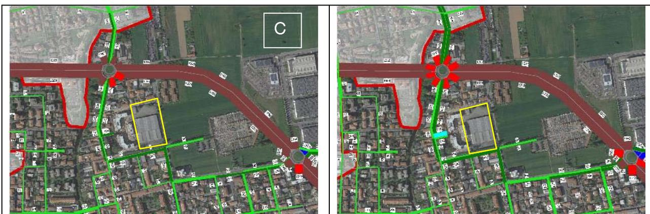
La lettura dei carichi veicolari rilevati nelle aree di trasformazione rivelano una sostanziale uniformità rispetto alle condizioni di fatto. Da evidenziare la riduzione dei carichi veicolari in prossimità del comparto Sub A, lungo gli assi di Via San Giuseppe e il tratto di prossimità di Via Vittorio Emanuele II.
