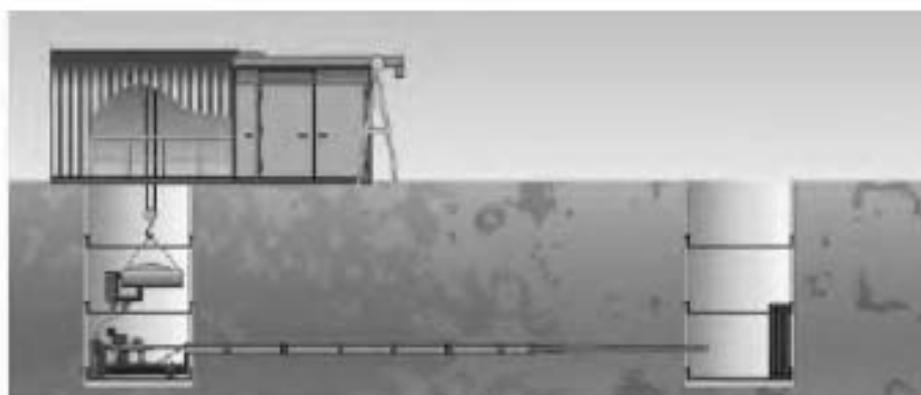
*Immagine – Microtunnelling, metodologia con tubo pilota a spostamento del materiale*<sup>96</sup>
