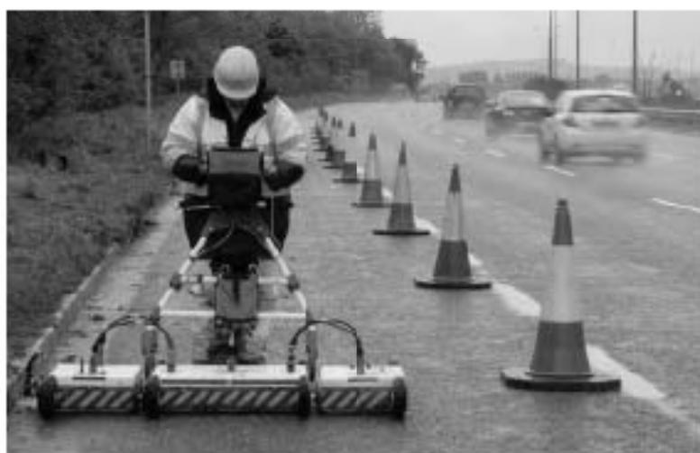
*Immagine – Esempio di rilevamento delle reti nel sottosuolo attraverso georadar*
