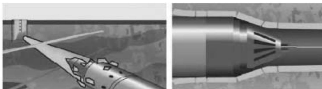
*Immagine – Pipe bursting (distruzione delle tubazioni per frantumatura ad espansione)*<sup>98</sup>
